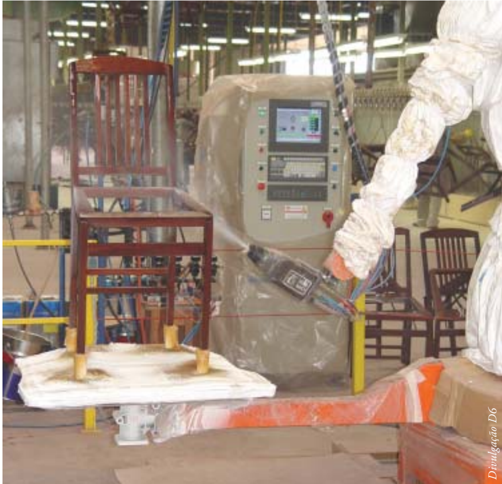
Robô de pintura: maior precisão e ausência de risco nas operações com vernizes e tintas
